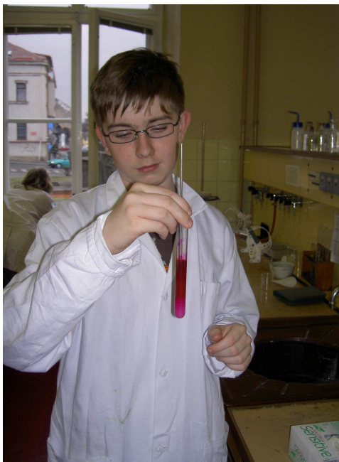
Obr.16 – Zásaditá reakce mýdla s fenolftaleinem
