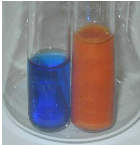
Obrázek 2: Reakce glukosy s Fehlingovým činidlem (vlevo před, vpravo po reakci).
