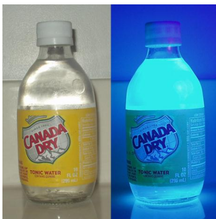
Obrázek 7: Tonik s obsahem chininu pod UV světlem, kde fluoreskuje (převzato z: http://en.wikipedia.org/wiki/Tonic_water ).
