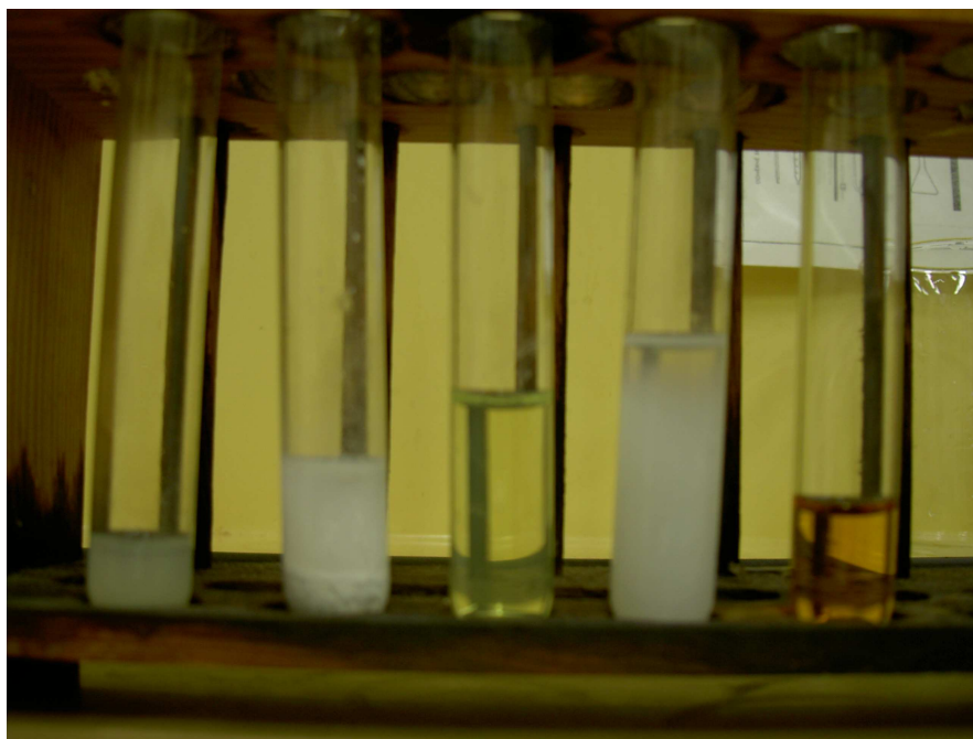
obr.15 – Důkazy iontů (v pořadí ve slinách \text{Cl}^- \text{SO}_4^{-\text{II}} \text{PO}_4^{-\text{III}} \text{Ca}^{-\text{II}} KSCN) ve slinách (foto E. Hájková)
