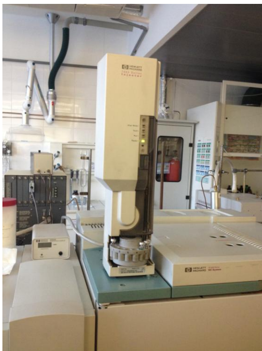
Obr. 4 Automatická dávkovací hlavice chromatografu
