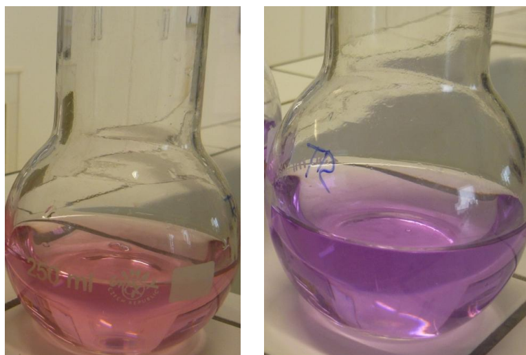
Obr. č. 16 a 17: barevná změna titrovaného roztoku
