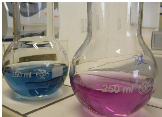
Obr. č. 15: barevná změna titrovaného roztoku
