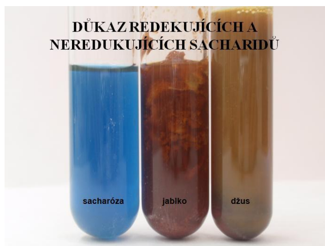
Obr. č. 6: Výsledky důkazů redukujících a neredukujících sacharidů
