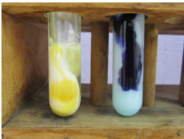
Obr.: Zkumavka vlevo – výsledek xanthoproteinové reakce, vpravo výsledek biuretové reakce
