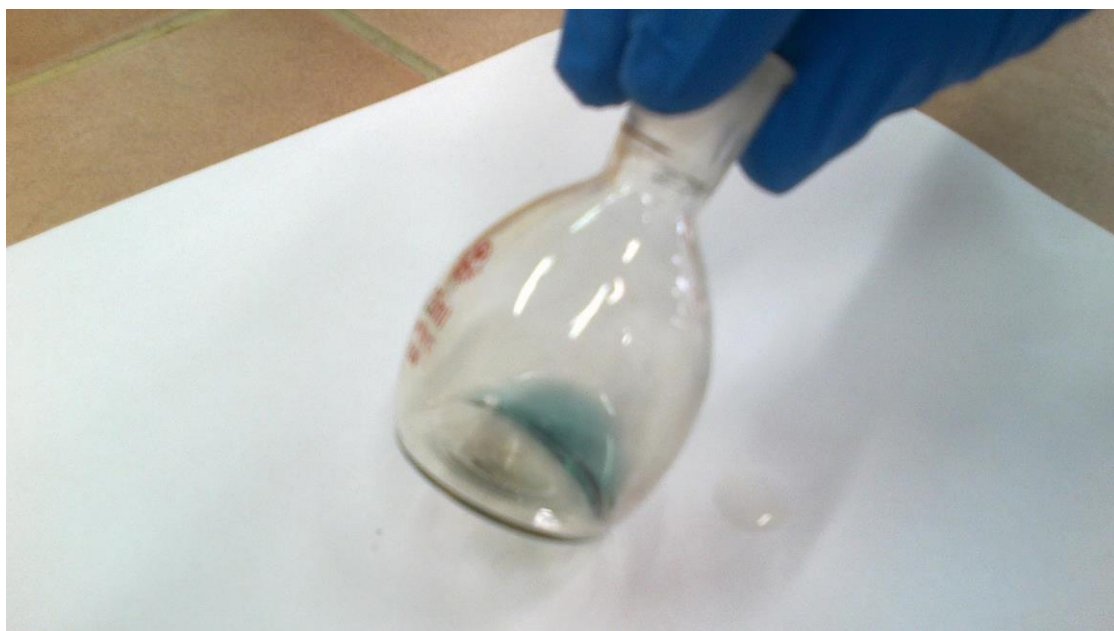
Obr.: důkaz železa ve výluhu z popelu
