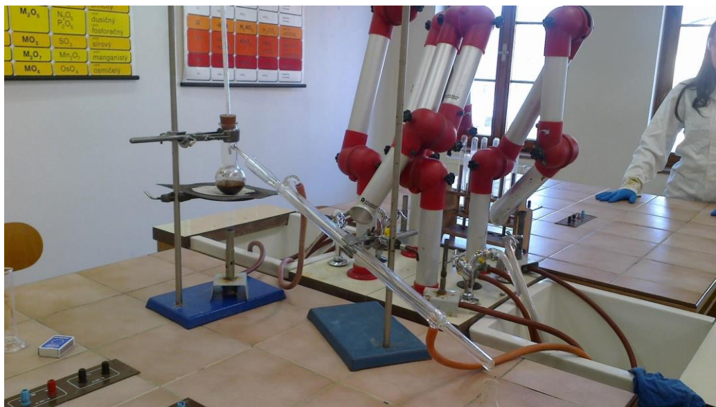
Obr.: izolace nikotinu - destilace tabákového roztoku
