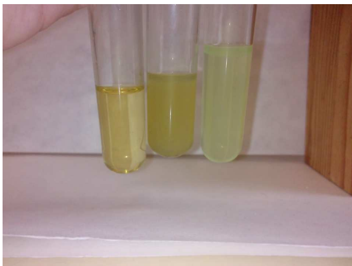
Obr. 55 – 1. zkumavka tableta celaskonu s vodou, 2. zkumavka roztok po přidání chloridu železitého, 3. zkumavka roztok po přidání hexakynoželezitanu draselného. (foto: N. Čandosová)
