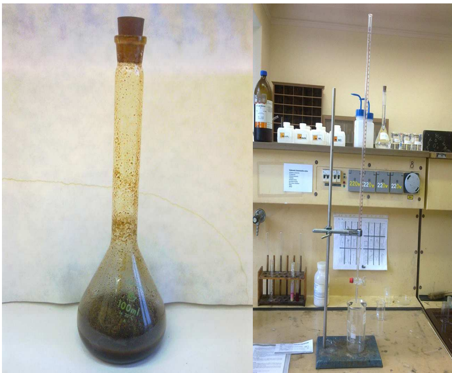
Obr. 64 - Směs tabáku, vody a NaOH. Obr. 65 - Titrační aparatura. (foto: T. Bašová)
