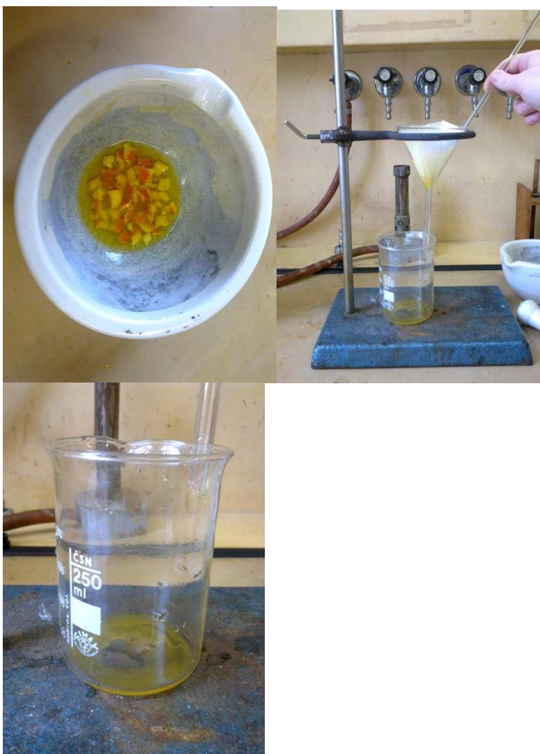
Obr. 58 – Směs po přidání tanolu Obr. 59 – Filtrační aparatura Obr. 60 – Přefiltrovaná směs pomerančové kůry a tanolu. (foto: L. Hladká)
