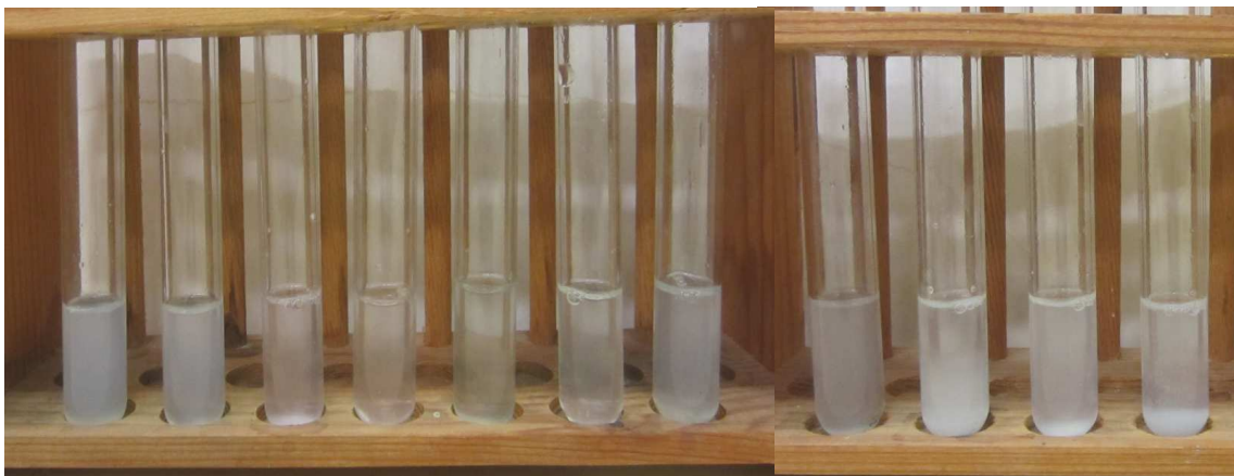
Obr. 37, 38 – 1. Zkumavka-líh, 2. Aceton, 3. Kyselina chlorovodíková, 4. Kyselina dusičná, 5. Hydroxid sodný, 6. Chlorid sodný, 7. Chlorid vápenatý, 8. Chlorid barnatý, 9. Dusičnan olovnatý, 10. Dusičnan kademnatý, 11. Dusičnan stříbrný. (foto: J. Friedová)
